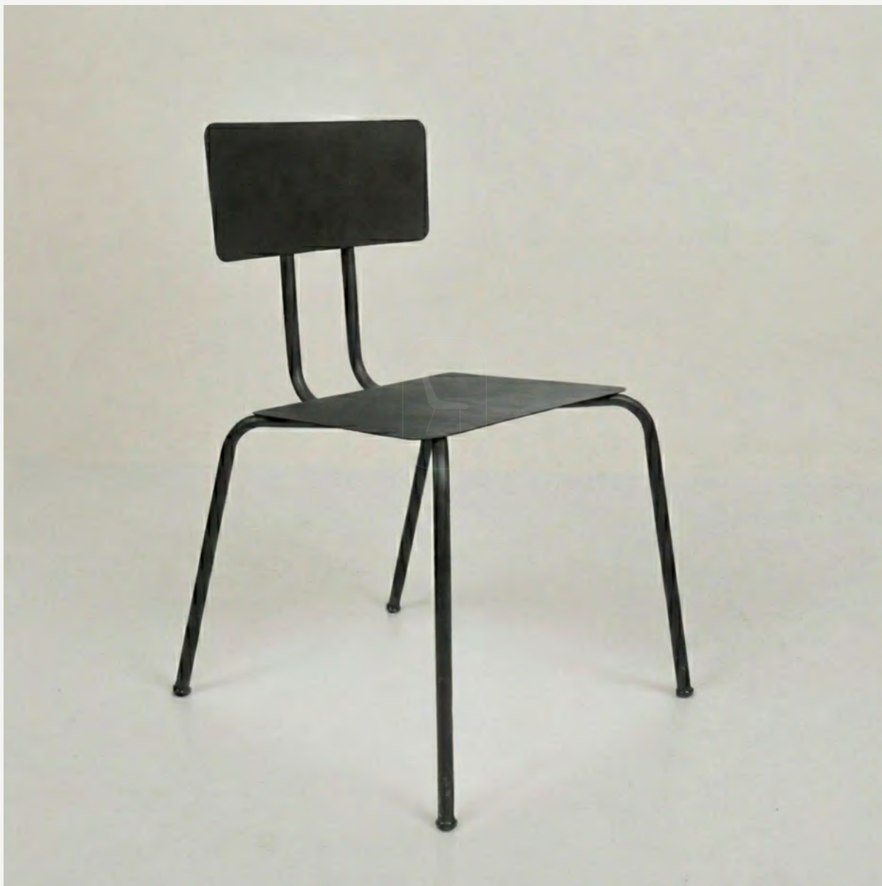
Silla GLEXT01 | Apto exterior Estructura caño baja. Asiento y respaldo chapa. Ancho total 500mm. Alto asiento 450mm. Alto total 820mm. Profundidad. 560mm.
